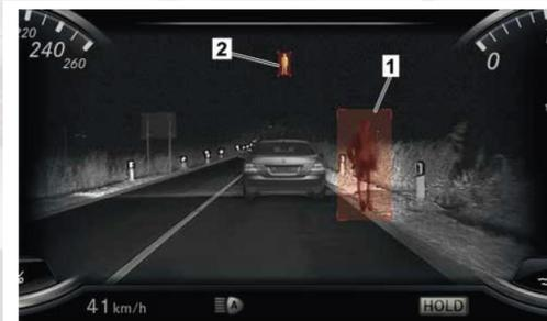
Affichage sur le combiné d'instruments dans l'obscurité (détection des personnes)
